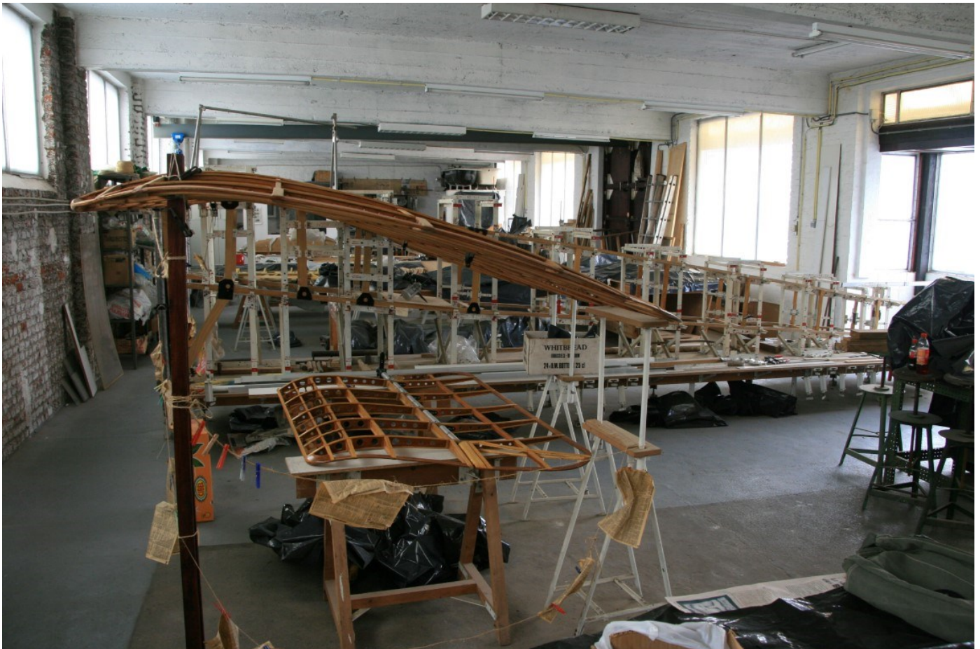
Vue du Blériot dans son bâti d'assemblage avec son aile gauche en place et un demi-empennage. Photo Marc Lecocq
