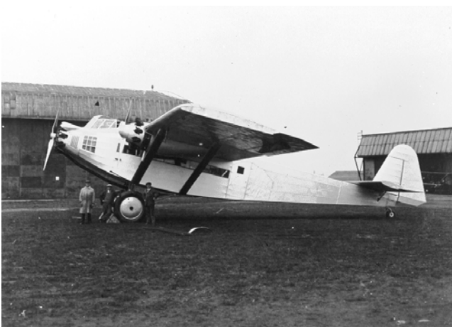
Deuxième version du S 11 avec la modification du fuselage arrière et de la dérive.
