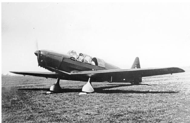
permettent l'exécution de toutes les gammes d'acrobaties courantes en vol normal ou inversé. Son train d'atterrissage est à large voie cantilever, muni d'amortisseurs à longue course et de roues à freins hydropneumatiques. Les matériaux utilisés dans sa construction sont l'acier au carbone soudable, le bois. (spruce, limba et contreplaqué de bouleau). Son revêtement est mixte, contreplaqué et toile enduite de nitro-cellulose.
