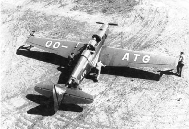
C'est un monoplan, monomoteur, à ailes basses semi-épaisses qui comporte un poste de pilotage à double commande en tandem. Le volume de l'habitacle permet d'utiliser l'avion pour l'entraînement aux diverses missions de T.S.F., photographies et reconnaissance. Un dispositif particulier permet d'occulter le poste arrière pour l'entraînement au PSV. Le coefficient de sécurité ainsi que les systèmes de lubrification et d'alimentation du moteur Renault Benagali 4 Pei,
