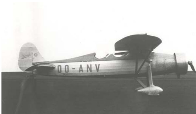
Le deuxième R-33 (OO-ANV) à moteur Renard muni expérimentalement d'un capot NACA durant l'été 1934. (AELR)
