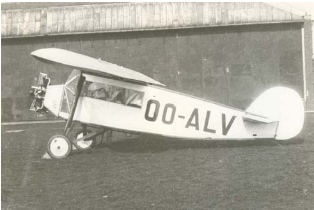
Le seul Renard R-17 dans sa version initiale, à nez court, montre bien les lignes sobres de l'appareil ainsi que ses importantes surfaces vitrées. (AELR)
