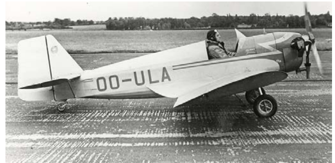
Au taxi en 1948, le Topsy Junior OO-ULA (n/c J111) équipé d'un moteur 2 cylindres Aeronca JAP J-99 de 36 CV avec un marquage Fairey « Junior » très nettement appliqué juste en avant du pare-brise. (Fairey)
